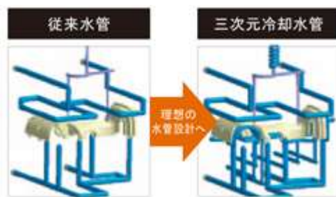
軽量化冷却管 (ホワイトインパクトの好意による)
